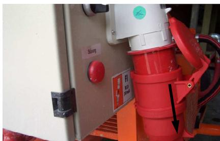
Abb. 70: Anschlusskabel entfernen
