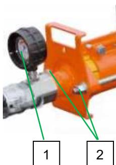
Abb. 55: Mörteldruckmanometer
